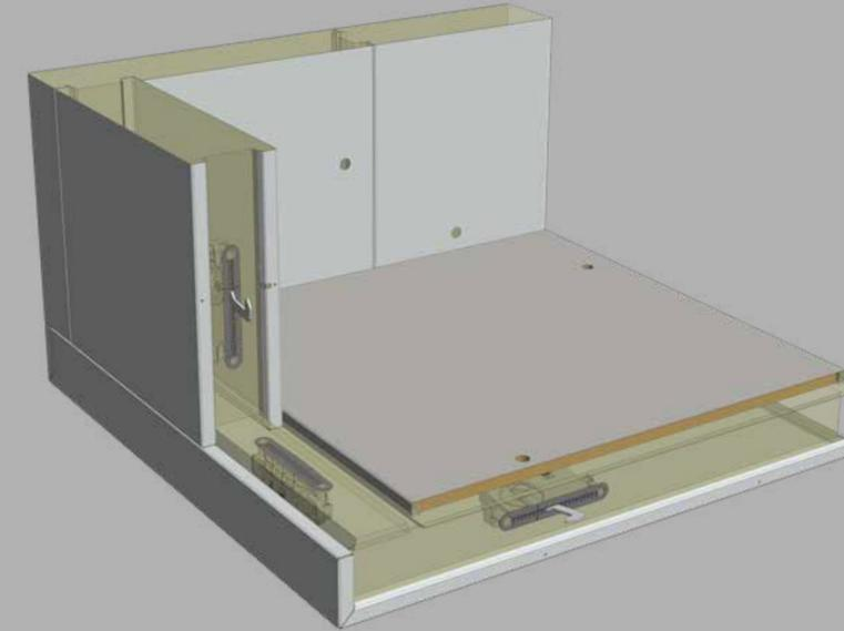
Das **ILKASYS**-System bietet für jede kältetechnische Anwendungsmöglichkeit die passende Isolierstärke. Damit können wir Temperaturbereiche von +80 °C bis zu -110 °C sicher gewährleisten. Unser bewährtes Nut-Feder-Verbundsystem mit eingeschäumten Exzentrerschließhaken garantiert eine 100%-ige Dichtheit für höchste hygienische Ansprüche. Wärmebrücken werden damit ausgeschlossen.
